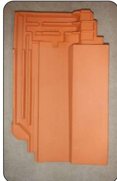
Bei diesen Dachziegeln wurde keine Feuchtigkeit an der Ziegelunterseite beobachtet (Sparrenneigungen 22° - 7°, Lattung 34.0 cm, Wassermenge von 250 mm/m<sup>2</sup>h, Windgeschwindigkeiten von 7.5 m/s, 10.0 m/s, und 12.5 m/s).
